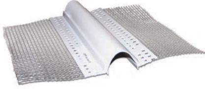
Giunto in PVC con rete in fibra di vetro di origine europea termosaldata da inserire tra i pannelli isolanti in presenza di giunti strutturali dell'edificio o in tutte le situazioni in cui è necessario garantire un'adeguata dilatazione per assorbire i movimenti di assestamento. Per pareti continue.
